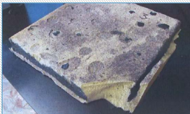
Fotografia 6: Próbką PU zdjętą z dachu płaskiego
