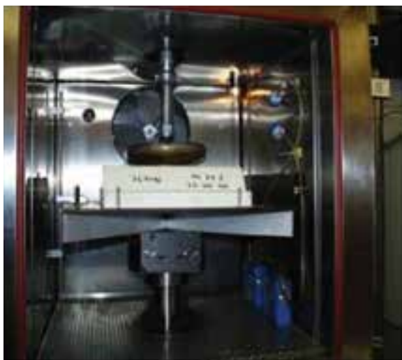
Kuva 4: MDI-pohjainen polyuretaanivahto dynaamisessa rasiustestissä kammiossa, jossa on näytteenottopumppuja ja -suodattimia.
