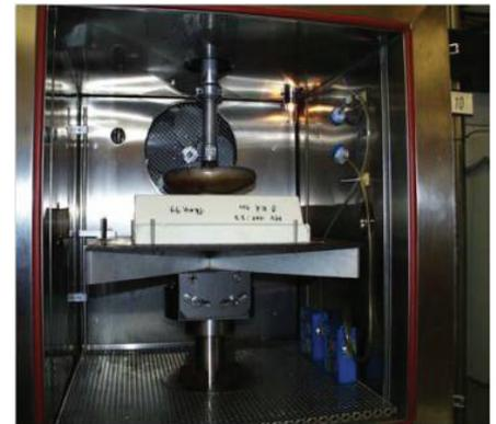
Figura 4: Espuma de poliuretano a base de MDI en la cámara de ensayos de fatiga dinámica con bombas de muestreo y filtros de muestreo
