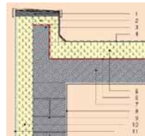
Kuva 4: Kylmäsilta ullakon kautta (Lähde: IVPU:n ohjeet Flachdach dämmen mit Polyurethan-Hartschaum, 2011, sivu 8)
