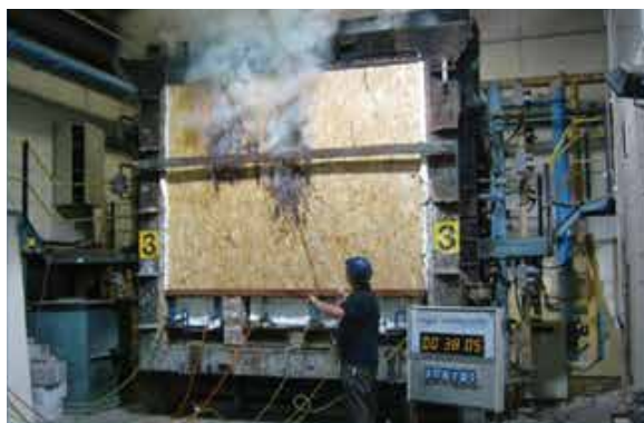
Kuva 4: PIR-testi 306703 päättyy 38 minuutin kohdalla
