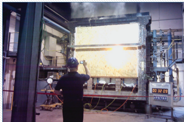
Ilustracja 3: Badanie włókna szklanego 306702 zakończono (wystąpił błąd) w 32 minucie
