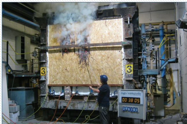
Ilustracja 2: Badanie PIR 306703 zakończono (wystąpił błąd) w 38 minucie
