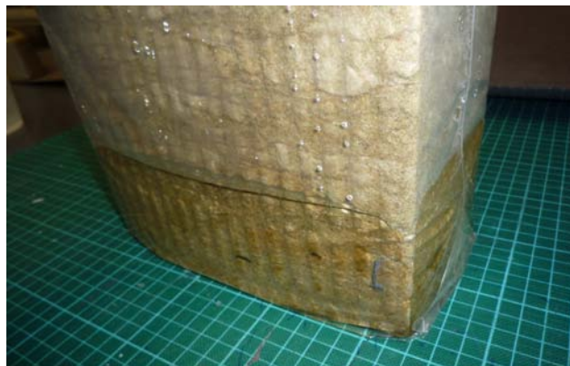
Abbildung 4: Mineralwollequader mit definiertem Wassergehalt in Kunststoffolie verpackt
