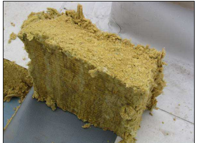
Abbildung 24: Probe Nr. 5 mit stark verminderter Druckbelastbarkeit
