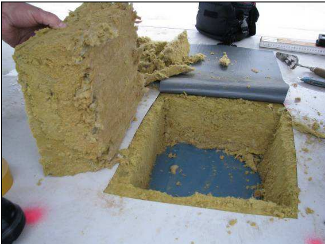
Abbildung 23: Probe Nr. 1 mit hoher Druckbelastbarkeit
