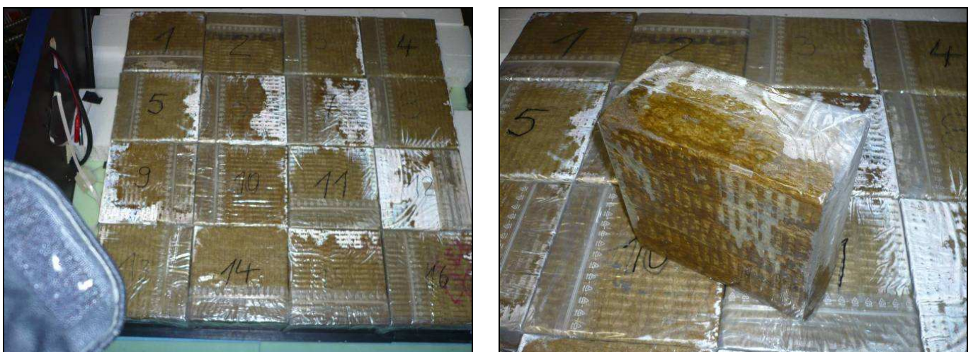
Abbildung 47: Für die Temperaturwechsellagerung vorbereitete Proben
