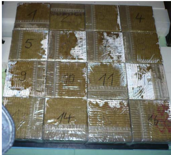
Abbildung 5: Anordnung der Mineralwollequader auf der unteren Temperierplatte
