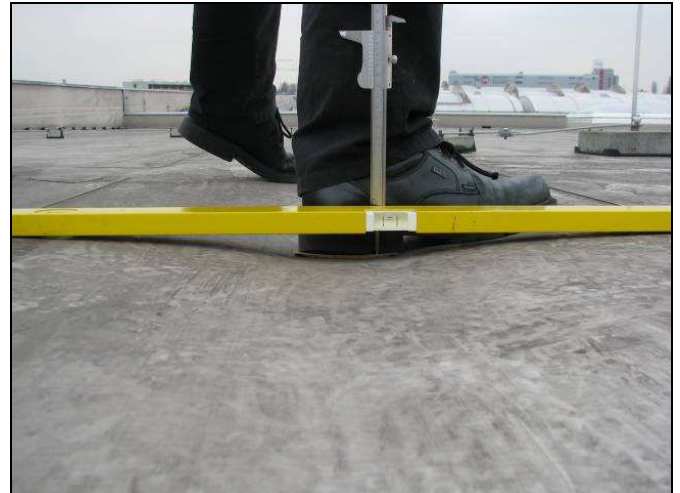
Abbildung 6 und 7: An besonders weichen Stellen wurden Verformungsmessungen mit Hilfe einer Hartfaserplatte und einem Rechteckrohr (Wasserwaage) durchgeführt. Rechts eine relativ große Verformungstiefe von ca. 33 mm.
