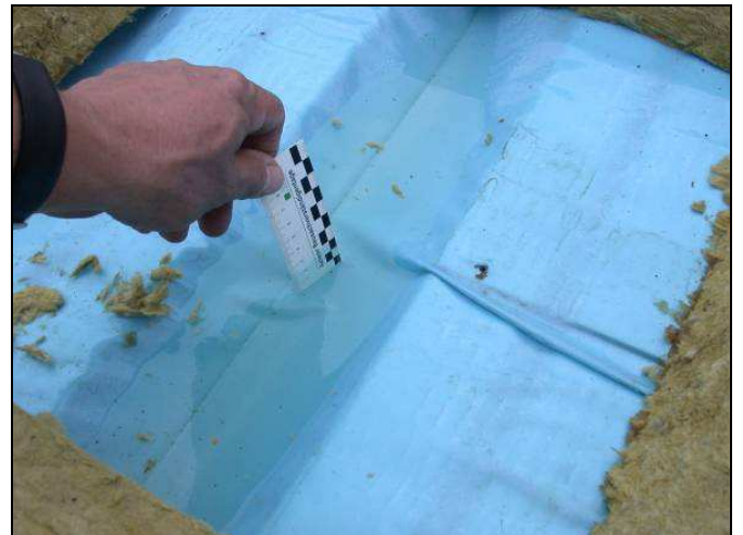
Abbildung 16 und 17: Probestelle im Bereich einer Kehle mit lang anhaltend stehendem Wasser
