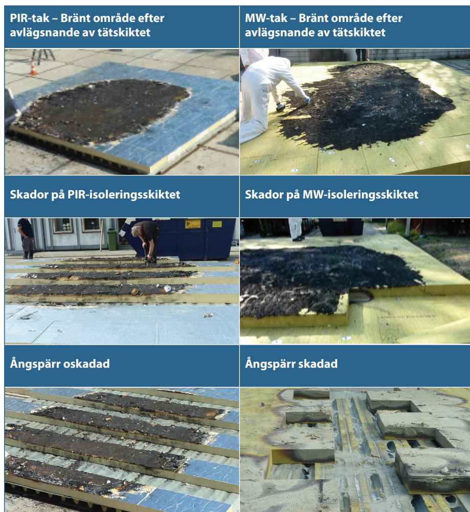
Figur 5: Bilder av isoleringskiktet och ångspärrarna efter testet
